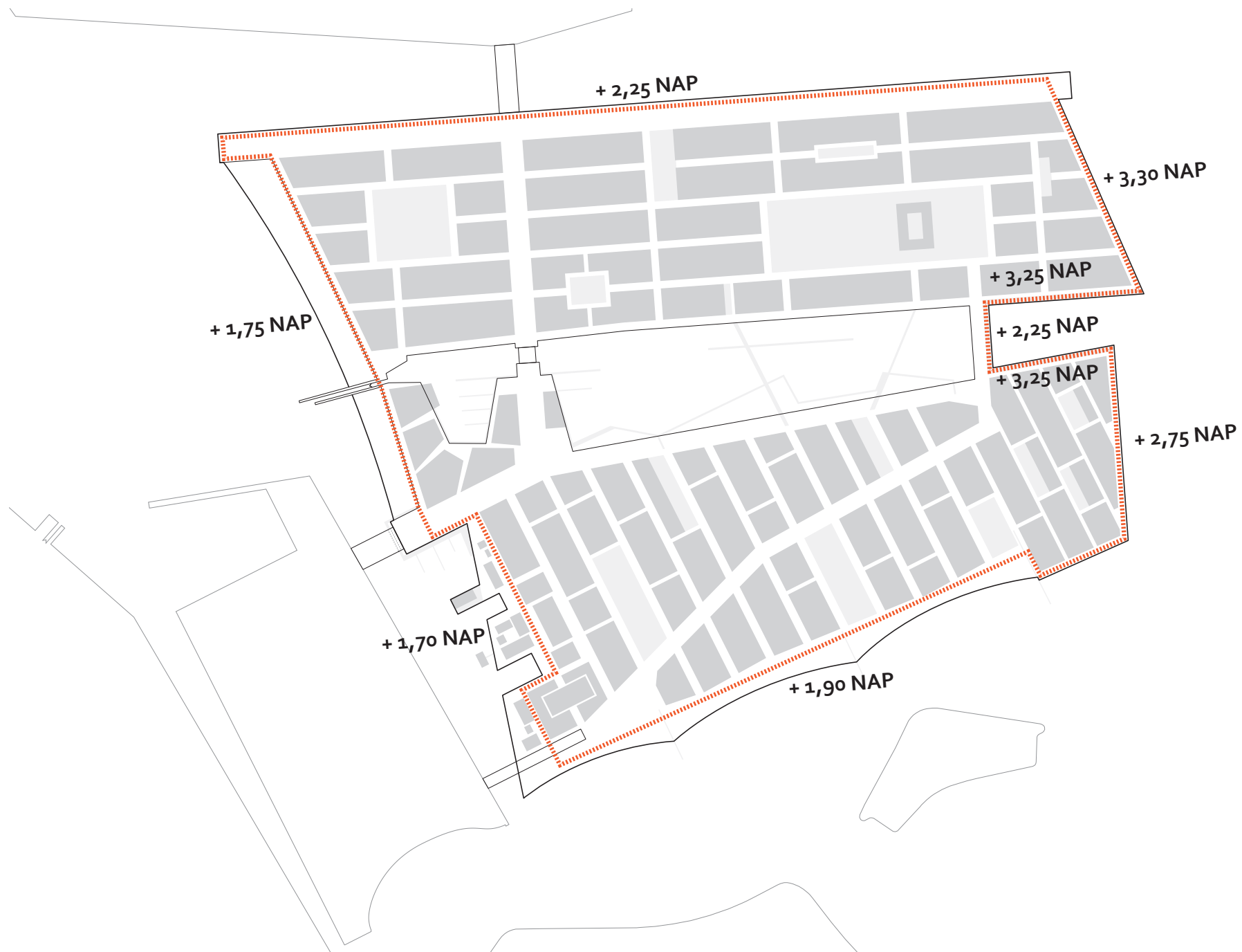
Afb. 10.5 Plankaart met schematische weergave van de waterkeringen
